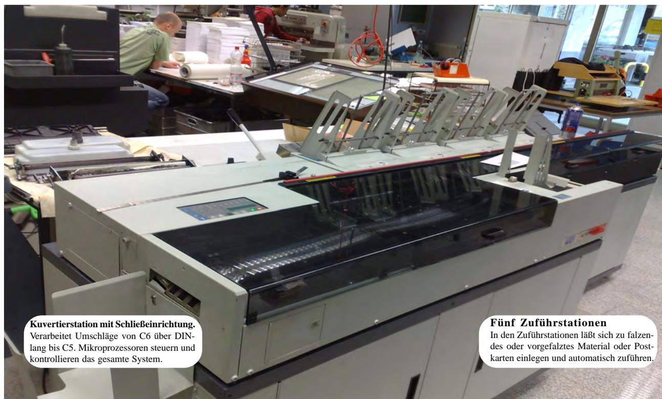
**Kuvertierstation mit Schließeinrichtung.**
